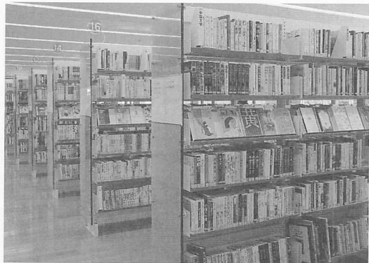
②書架システムパーツの例 「北茨城市立図書館」：側板サイン（A3紙差替式）。展示台（1連用+1冊用）、棚見出しサイン、ブックエンドは木製棚板の溝に引っ掛け、前面をそろえつつ地震時に落下させない工夫等
